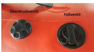
Der Nenndruck der Schlauchkammern beträgt 0,25 Bar. Diese Angabe finden Sie auch auf den runden Ringen welche um die Füllventile EV 55 liegen.
